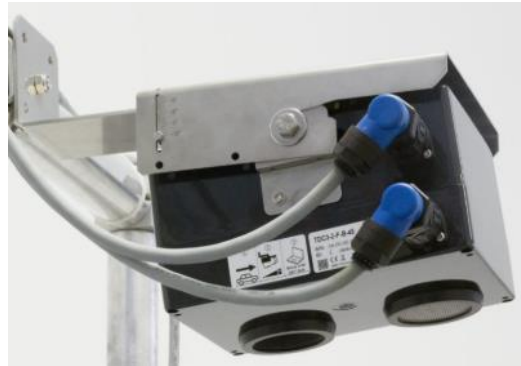
Joonis 1.16 Adec TDC-3 sensor
