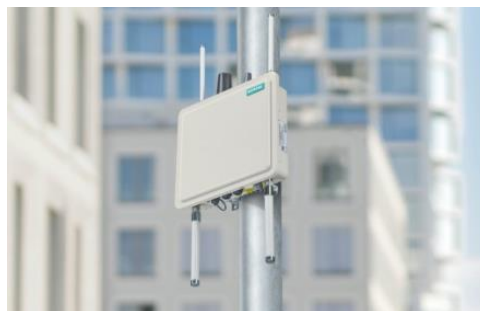
Joonis 2.3 Siemens SiTraffic RSU
