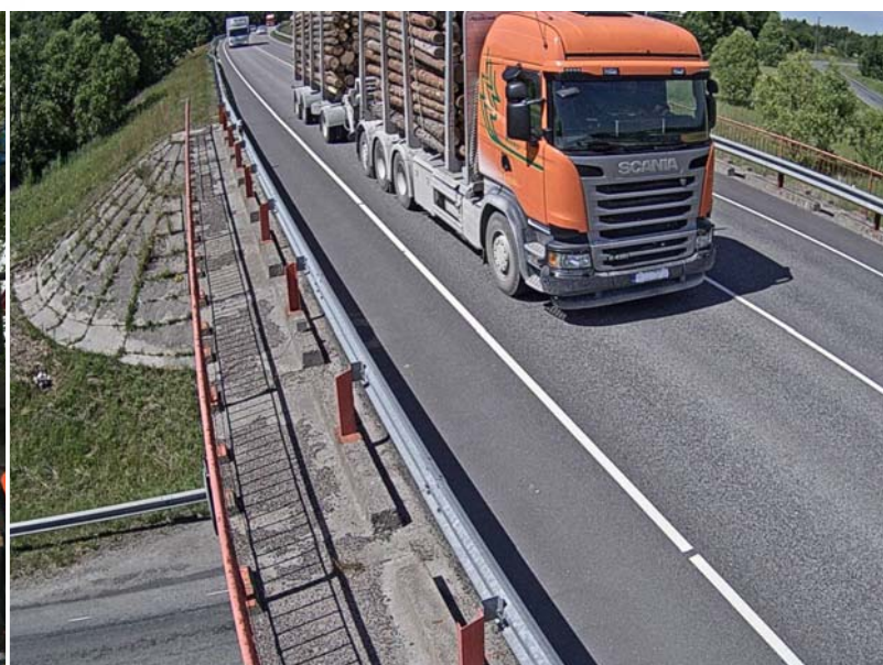
Foto 3. 2018. aastal Sanga viaduktil iBWIMi mõõtmiste käigus fikseeritud veoki tegelik mass on 82,8 t.
