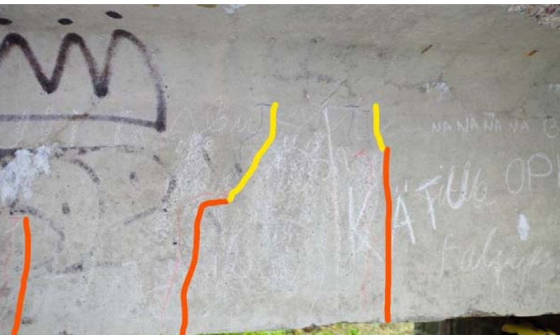
Fotod 5 ja 6. Pragude tekkimine sillataladele veoki koormuse all. Punasega on tähistatud 52tonnise veoki mõju. Kollasega on märgitud juurde tekkinud praod, kui sama veokit koormati 60 tonnini.
