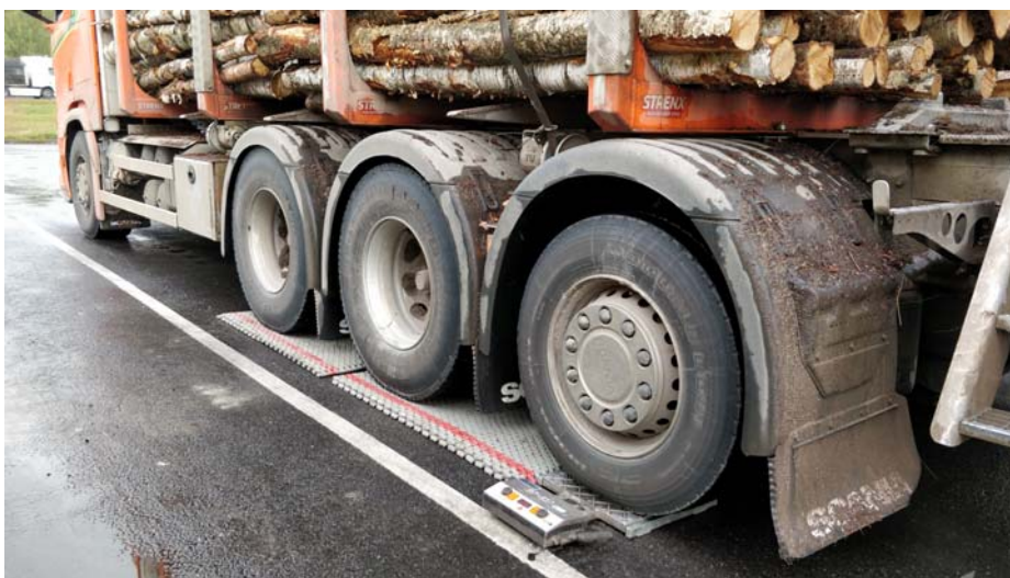
Sõidukeid kaaluti kalibreeritud teljekoormuskaalude abil telgede kaupa. Kaaludel seismise ajal vabastati sõidupidur ja jälgiti, et kõik rattad toetuvad täielikult kaaluledele.
