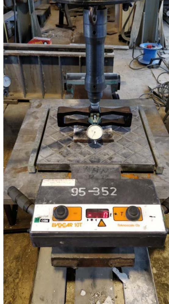
Teljekoormuskaalude kontroll Teede Tehnokeskuse laboratooriumis.
