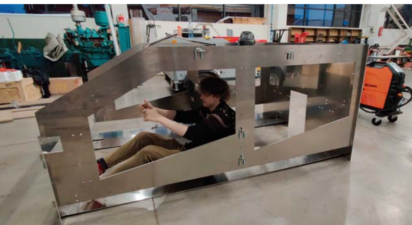
Esimesena valmib kere välisvorm. Neljakohalise võistlusauto salongi kaitseb toruraam, kere tuleb süsinikkiust ja päiksepaneelidest.
