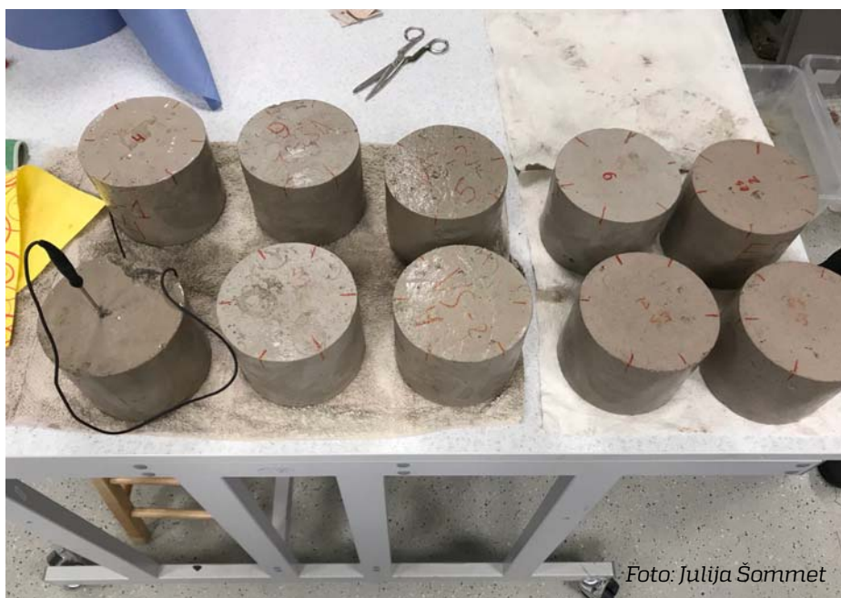
Primaarse sideainena põlevkivituhka sisaldavast stabiliseeritud segust proovikehad Tallinna Tehnikakõrgkooli laboris.
