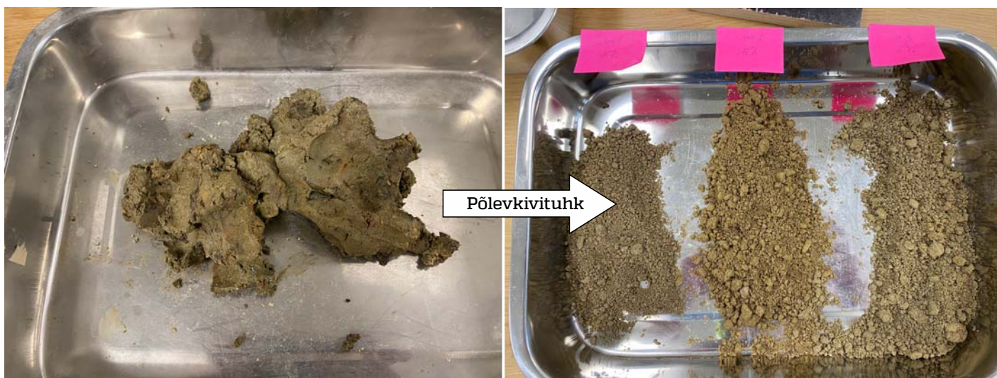
Liigniiske moreenpinnase segamisel põlevkivituhaga muudeti plastiliinitaoline pinnas liivataoliseks.
