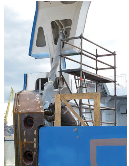
Tõllu ramp ja hüdro-silindrid on tehases juba vahetatud, töömees keevitab avamismehha-nisme. Foto: Madli Vitismann
