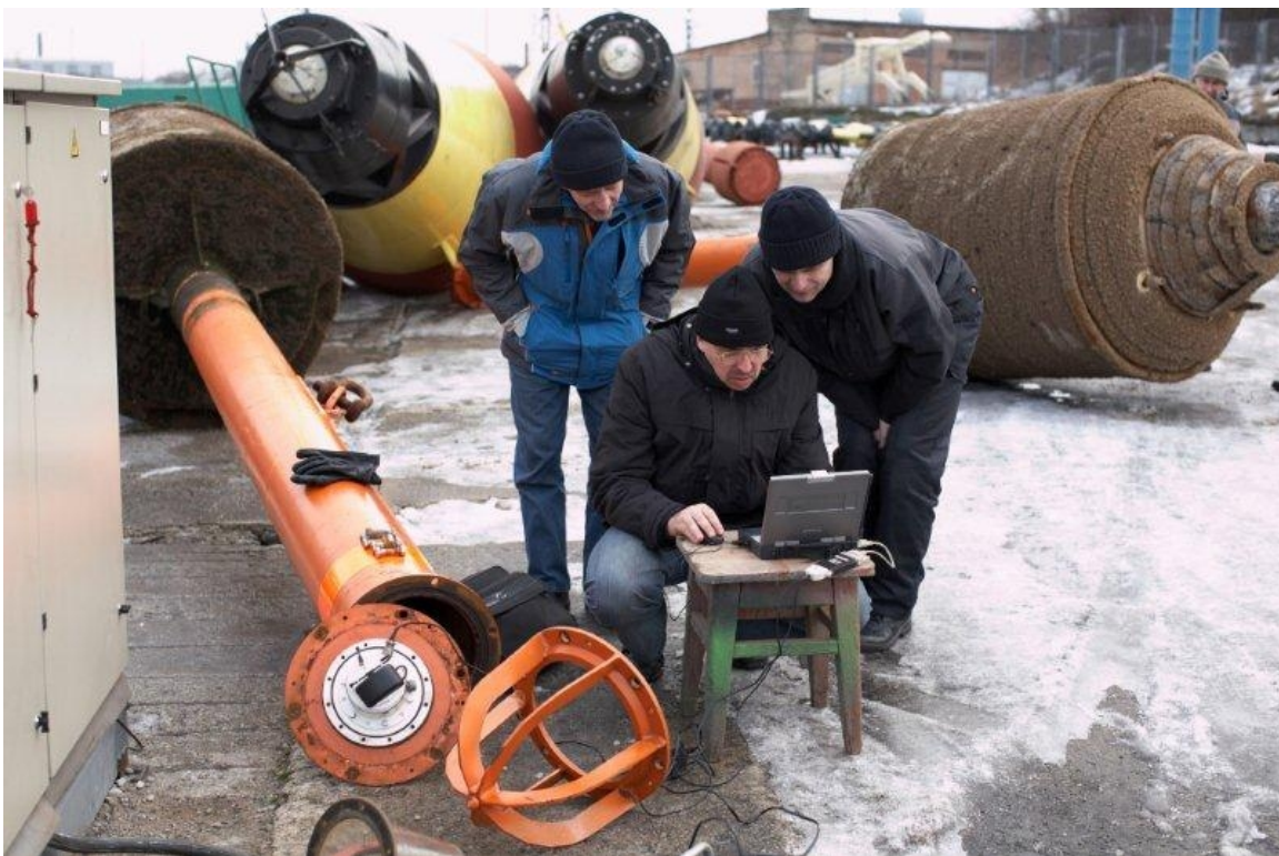
Fotol: poi elektroonika remont Autor: Leo Käärmann
