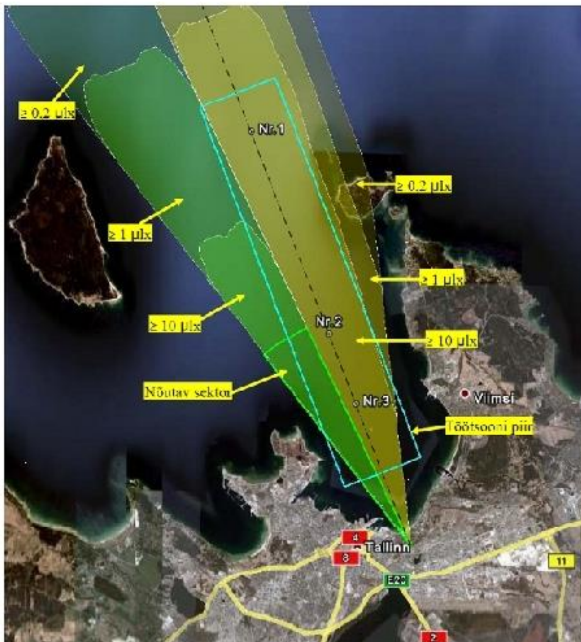
Joonis 12. Tallinna alumise tuletorni sihi- ja sektorlaternate projekteeritud nähtavusala laternate tööea alguses (näidatud on ka teljepoid nr 1, 2 ja 3)
