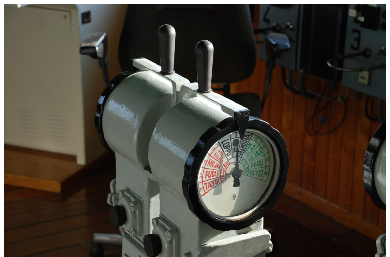
Tarmo sillal asuv masintelegraaf, millega kapten või tüürimees annab mehaanikule masinaruumi teada, millist käiku kasutada
