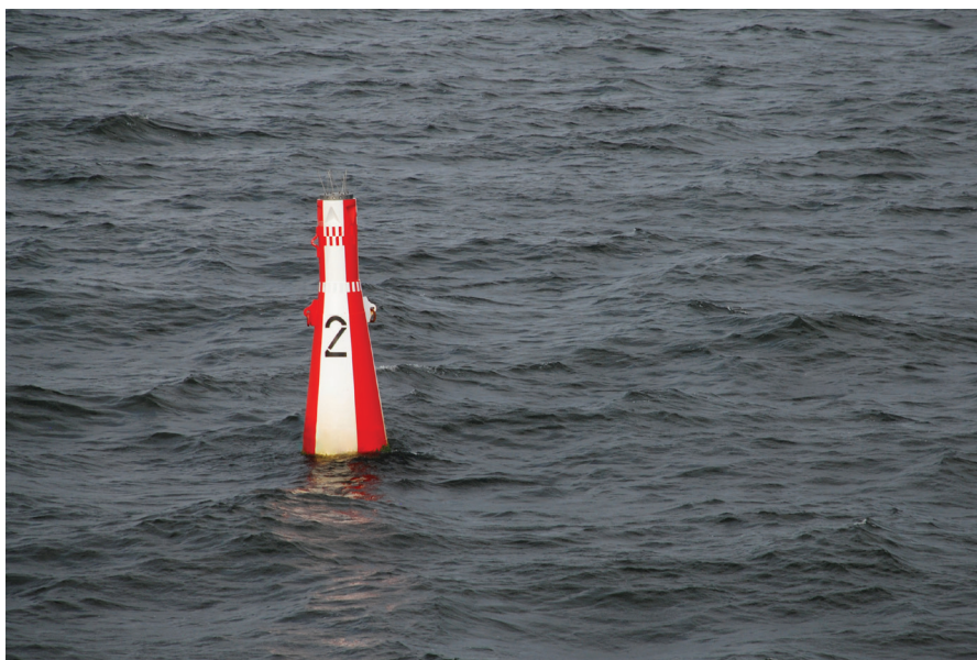
Tuleb vaid tunda navigatsioonimärke, et kindlalt öelda: see siin on laevatee teljepoi.
