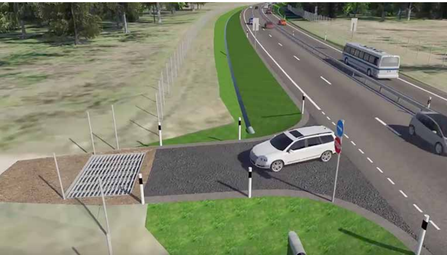
2+1 lõikudele paigaldatakse ulukipiirded, mahasõidud varustatakse ulukirestidega.
