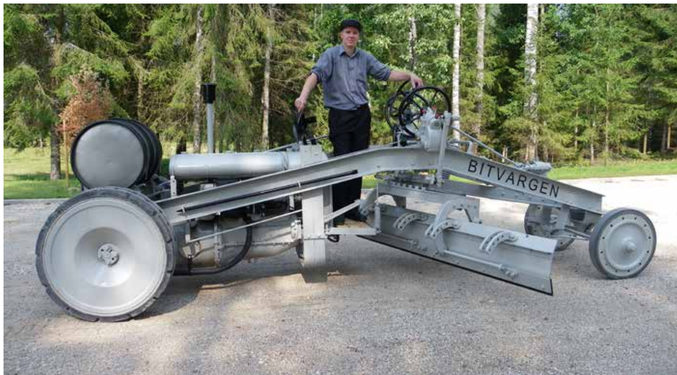
2010. aastal taastas aktsiaselts Grader Service Bitvargeni teehöövli Eesti Maanteemuuseumi jaoks töötava eksponaadina pea 100% originaaldetailidest.
