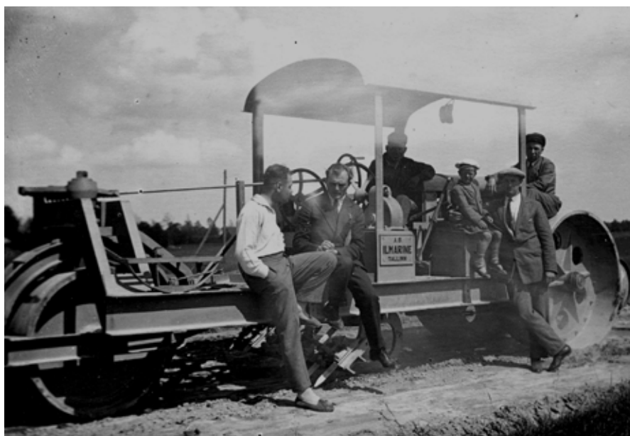
Rootsi eeskujul Ilmarise tehases 1930. aastate algul valminud rull-teehöövli ühendas rulli ja hoovli omadused ühes masinas.
