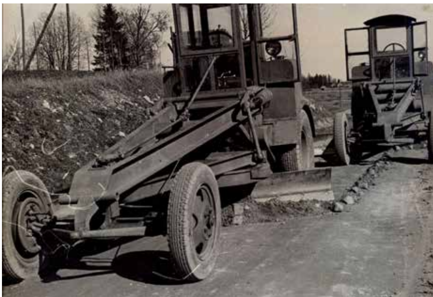
Sõjaeelse iseseisva Eesti teehõõvliehituse koolkonna ehitustraditsioonid taas elustasid pärast sõda, kui 1948. aastal valmis Paides insener Arnold Volbergi konstrueeritud iselikkuv teehõõvel V-1. Esimene omataoline terves tollases NSV Liidus.
