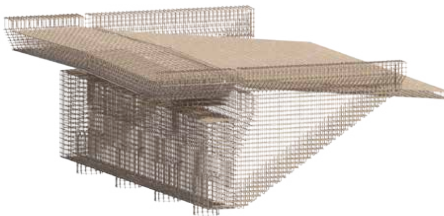
Möniste silla detailne 3D mudel võimaldab ühelt poolt genereerida täpse mahutabeli ning teisalt hinnata projekteeritud rajatise eri osade omavahelist sobivust.
