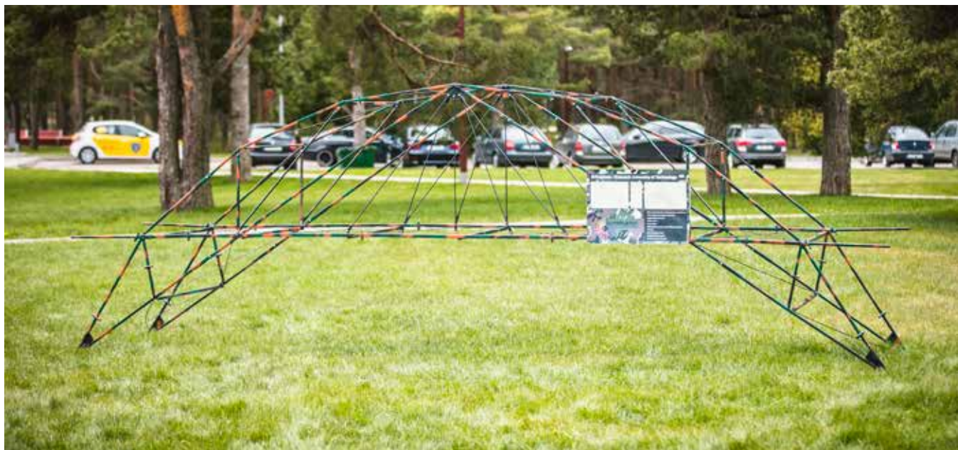
Poola Białystoki Tehnikaülikooli võistkonna BriCojonese sild. Ehkki pealtnäha õbluke, pidas see vapralt vastu 1000 kg koormamisele.
