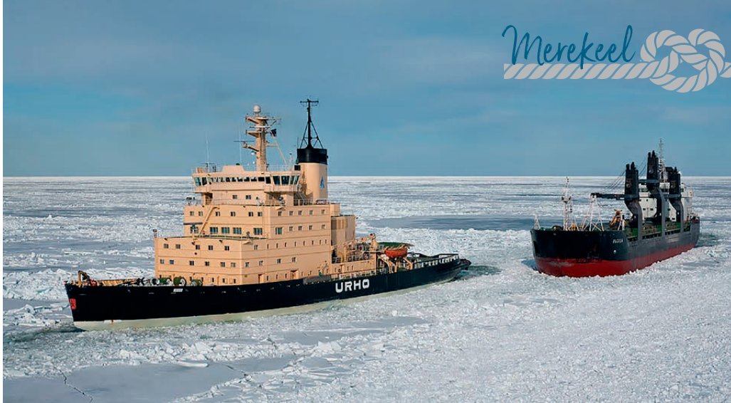
Soome jäämuraja „Urho“ oli esimene Helsingis Wärtsilä tehases ehitatavatest sama tüüpi jäämurajatest. Laevade pikkus on 104,6 m, laius 23,8 m, vööris ja ahtris kaks pötkurit, diiselelektrilise jõuajami võimsus 22000 hj. Nii tagatakse Põhjalahel aastaringne laevaliiklus.
