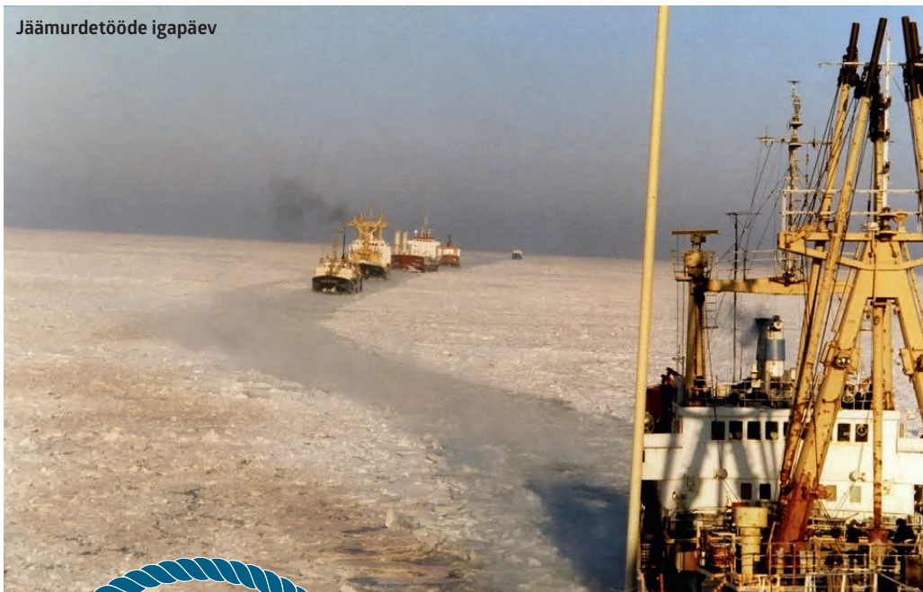
Soome jäämuraja „Urho“ oli esimene Helsingis Wärtsilä tehases ehitatavatest sama tüüpi jäämurajatest. Laevade pikkus on 104,6 m, laius 23,8 m, vööris ja ahtris kaks pötkurit, diiselelektrilise jõuajami võimsus 22000 hj. Nii tagatakse Põhjalahel aastaringne laevaliiklus.
