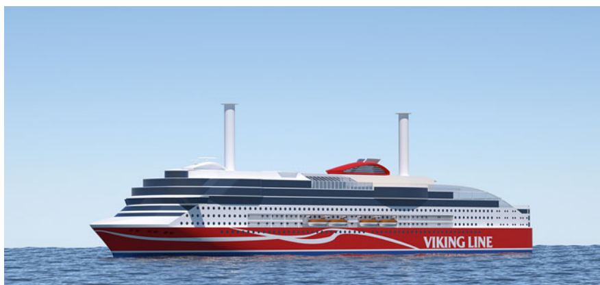
Uuel parvlaeval aitavad kütust säästa kaks rootorpurje. Foto: Viking Line
