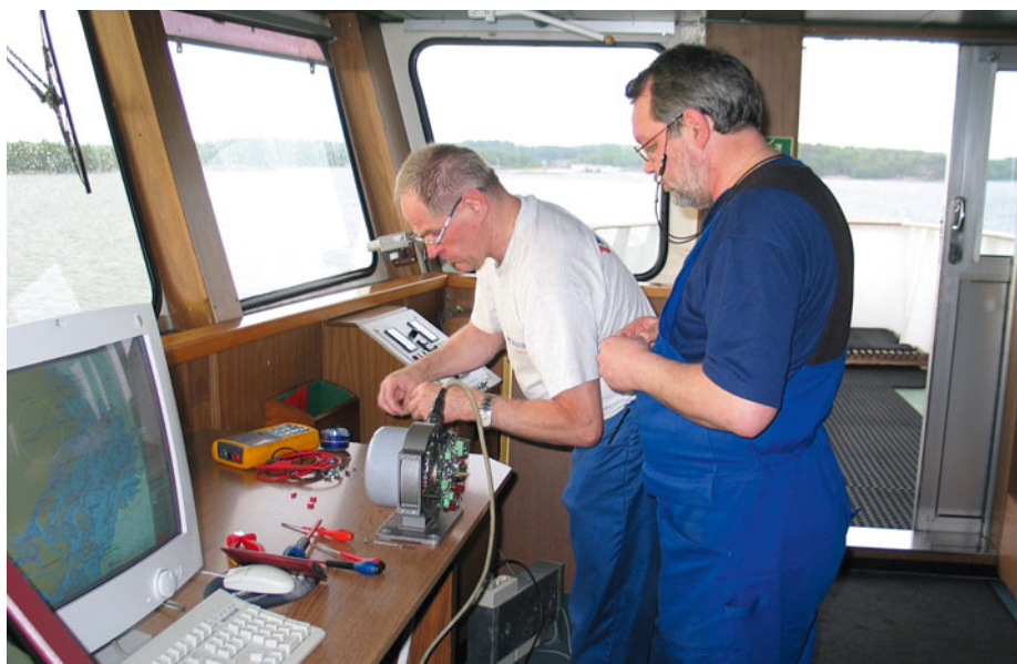
„Fantaasia“ elektrik ja automaatik remontisid juunis 2003 silla tiiva ukse ees güroskoobil põhinevat RoT (rate of turn) seadet. Tänapäeval on selline seade mahutatud juba paljudesse nutitelefonidesse. Foto: Madli Vitismann
