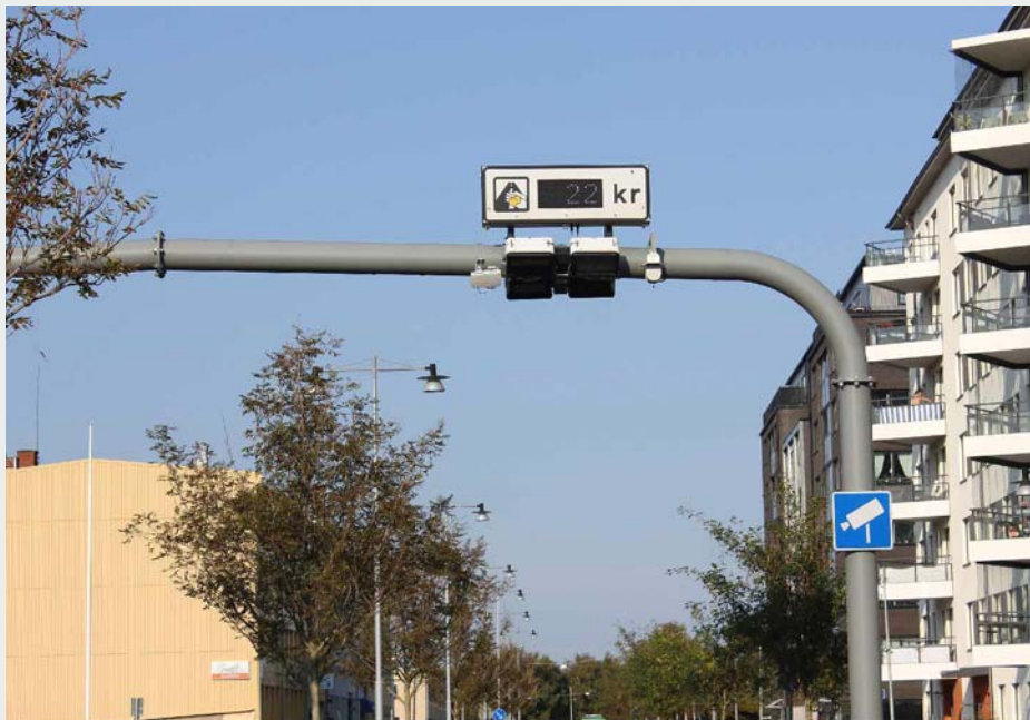
Göteborgi kontrollpunkti kaamerad tuvastavad sõiduki automaatselt. Tablool näeb hetkel kehtivat maksusummat.
