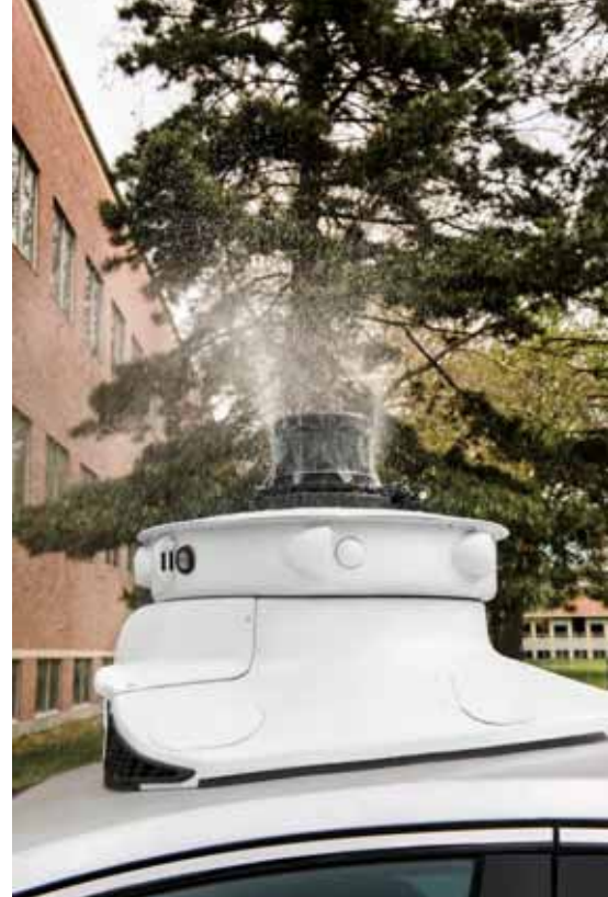
Sensorite putukapesu: nagu inimjuhile on vaja puhast esiklaasi, nii peavad ka sensorid puhtad olema.
