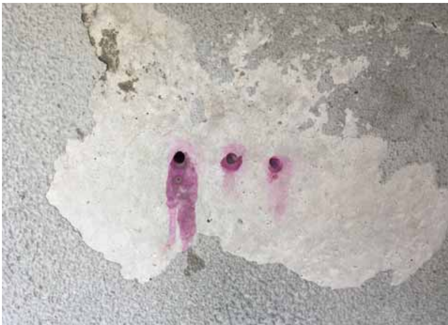
Karboniseerumise määramine vastavalt standardile EVS-EN 14630.
