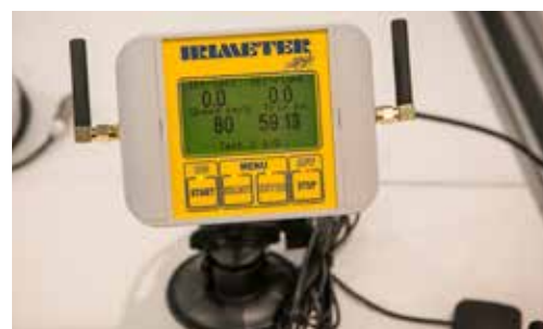
Eestlaste leiutatud Irimeter-1 võimaldab sõiduautole paigutatult mõõta teekatte tasasust igal hetkel.
