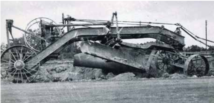
Haagishöövile monteeritud kraavisahk maanteede kraavitamiseks.
