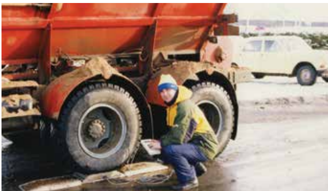
Eestimaine teljekoormuse mõõtmise seade, mille eest tahtsid valmistajad liiga kõrget hinda. Välismaine oli isegi odavam ja parem.
