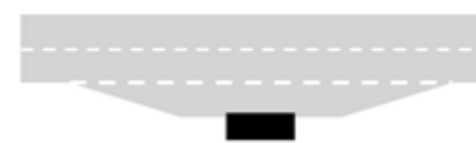
Praegu kasutusel olev lahendus. Ooteplatvorm paikneb bussipeatuse tasku sirge osa ääres keskel.
