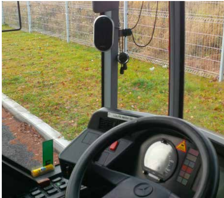
Bussi salongis esiakna paremas ja vasakus servas asuvad mobiiltelefoni suurused tablood, mis bussijuhile ohust märku annavad.
