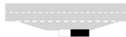
Uus lahendus. Ooteplatvorm on paigutatud bussipeatuse tasku sirge osa lõppu.
