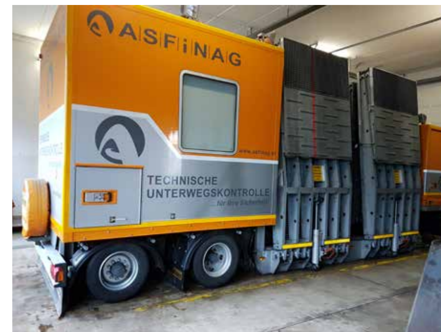
Veoaudote tehnokontrolli seade Wörgli teemeistripunktis Austrias
