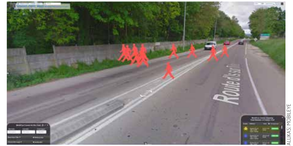
Prantsusmaal Dijoni linnas on Mobileye Shield+ paigaldatud prügiautodele, mis kaardistasid muu hulgas sellise ohtliku koha, mida suure tõenäosusega muidu ei olekski avastatud. Tõenäoliselt ületavad jalakäijad selles kohas teed madalama aiapiirde tõttu, et oma käiguteed lühendada.
