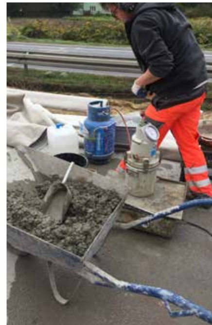
Käsil on paigaldatava materjali koonuse ja õhusisalduse kontrollkatsetamine töömaal. Kontrolli viib läbi järelevalvemeeskonna liige. Foto on tehtud Poolas.
