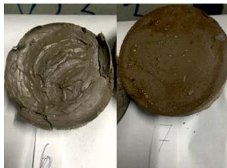
Joonis 1. Vasakul: katsekeha, mille segu kasutatud kuivainet ei kuumutatud; paremal: katsekeha, mille segu kasutatud kuivainet kuumutati enne kokkusegamist 500 °C juures.
