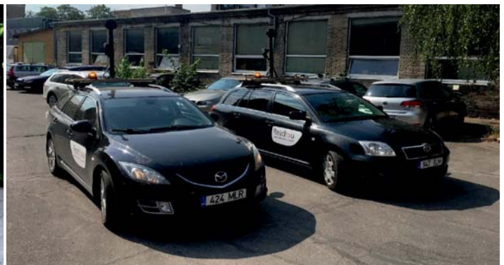
Ladybugi kaameraga varustatud video koostamise autod.
