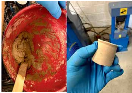
Joonis 2. Vasakul: optimaalne segu, millest valmisid kõige tugevamad katsekehad; paremal: optimaalsete omadustega katsekeha. Valmimiseks kasutatud segu oli voolavam ja pärast tihendamist saavutatud tekstuur oli ühtlane.
