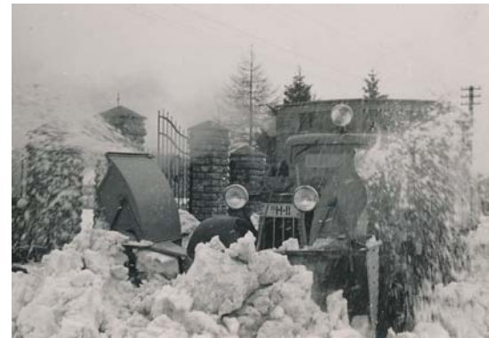
Boris Upine eestvõttel Harju maavalitsuse teedeosakonna töökojas konstrueeritud veoautole International monteeritud rootorlumesaha katsetamine 1936. aastal.
