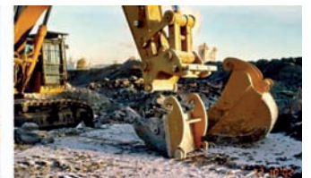
Ekskavaator-kobesti tööorgani vahetamine
