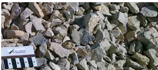
Joonis 1. Täielikult ümardunud ja täielikult purustatud terad
