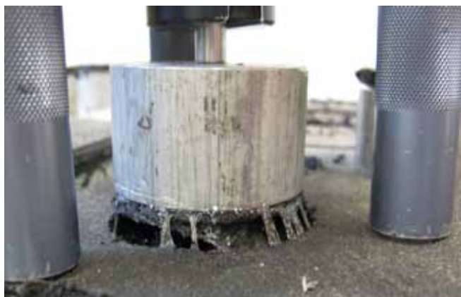
Joonis 1 Materjali purunemine nakkekatsel
