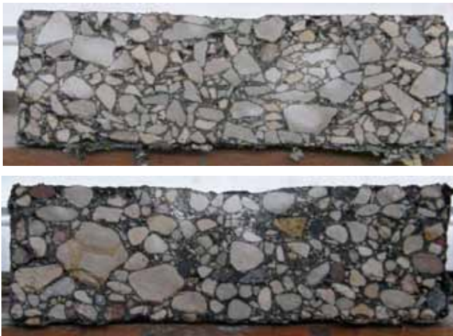
Joonis 5. AC 32 base proovikehad pärast rattaroota katsed
