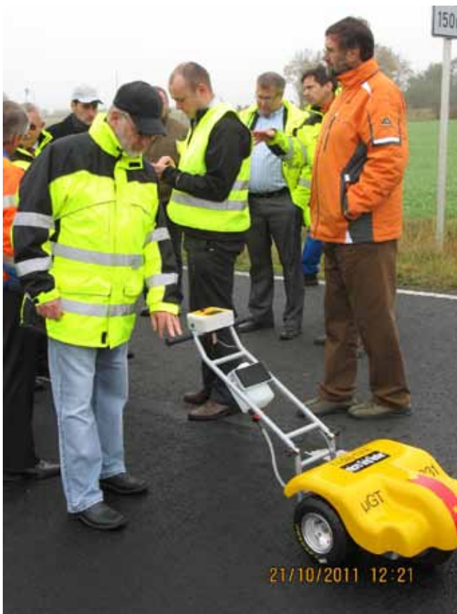
Foto 10. Artikli autor uurimas Micro Grip Testeri juhtpulti ja ekraani näitusid
