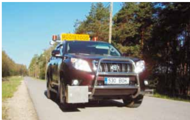
Joonis 1. Teekatte tekstuuri ja tasasuse mõõtmise seade Laser Texture Meter LTM-1
