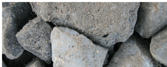
Foto 1. Nyköpingi lähedal asuval ehitusobjektil kasutatav šlakikillustik fraktsiooniga 0/125.
