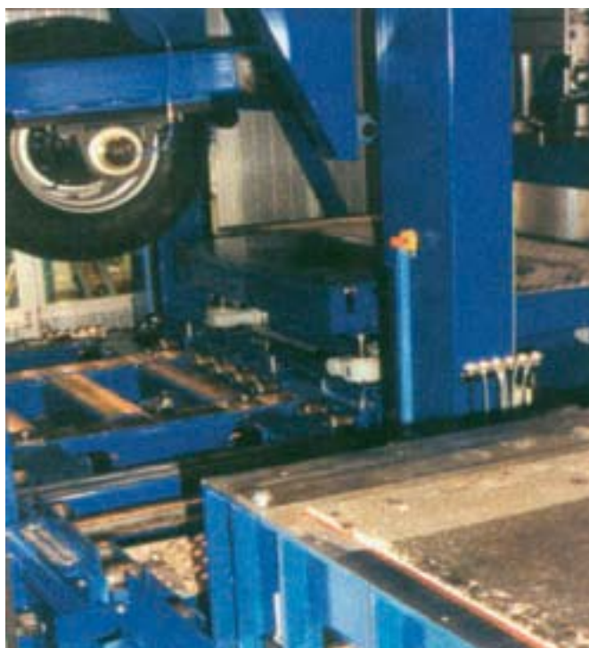
Joonis 5. DRI katte deformatsiooni testimisseade (DART)
