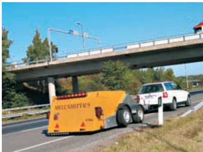
TKK autolaboratooriumis välja töötatud seadet NOTRA (Noise Trailer) kasutatakse teekatte müraomaduste määramisel
