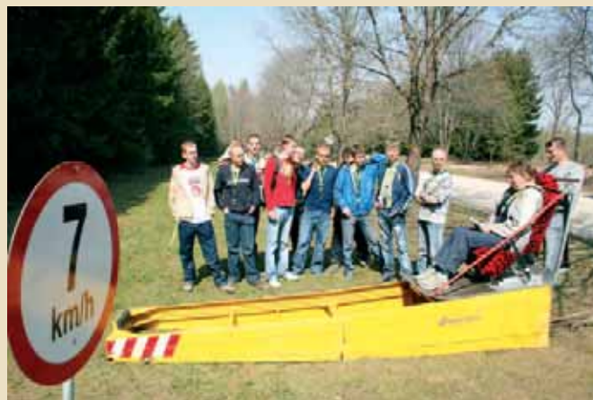
Autosõidukokkupõrke proovimine stendil kiirusel 7 km/h
