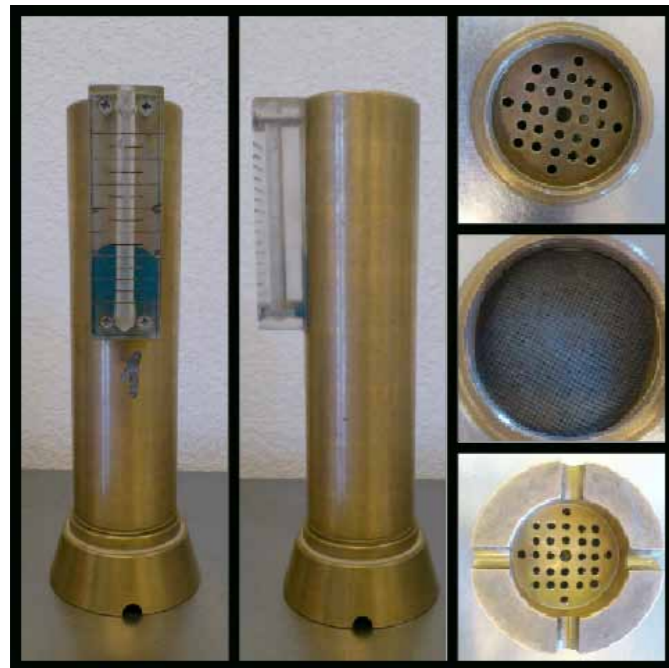
Sojuzdornii katseseade (kasutatakse liivpinnaste filtratsioonimooduli määramiseks), mida kasutasin oma lõputöös. Lõputöö teema: Dreenikihi ja muldkeha materjalide ning pinnaste filtratsioonimooduli määramise võimalused. Foto: Kadi Tuum.
