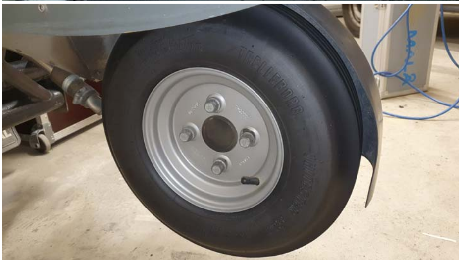
Talvel kasutakse ViaFrictionil pikisuunalise mustriga rehvi Trelleborg T520 4.00-8. Suviti on seadmel kiilasrehvi.
