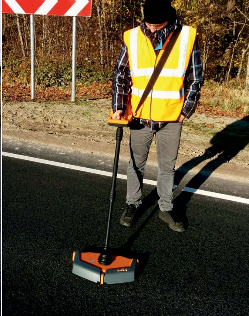
Pulss-induktsioonmeetodil töötava seadmega mõõtmine on kiire.
