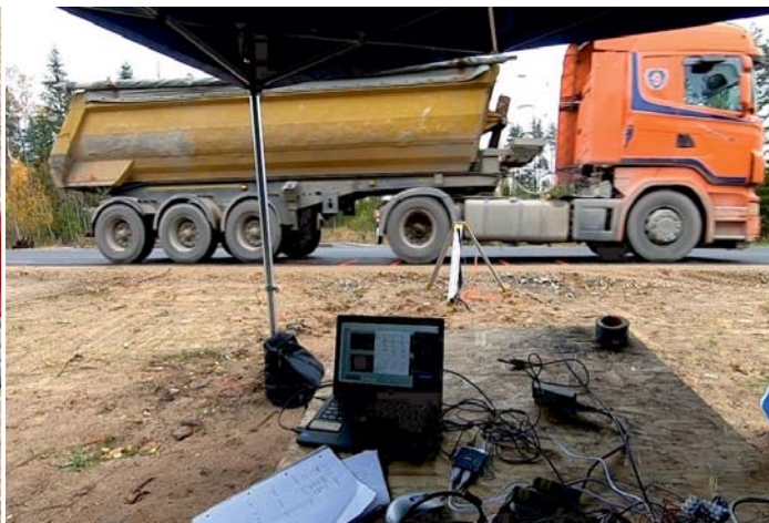
40tonnise etalonveoki möödumine mõõtepunktiist.
