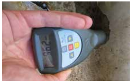
Tsingikihi paksuse mõõtmine kahjustatud kohast.
