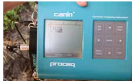
Tulemused seadme ekraanil. Mustaga on tähistatud kohad, kus on kooruv korrosioon.
