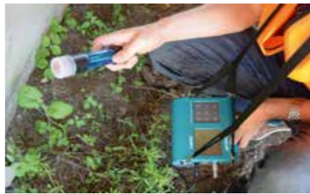
Proceq Canin+ pult ja vasksulfaadiga täidetud referentselektrood.
