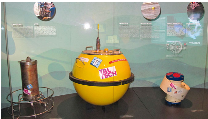
Merefüüsika tööriistad näituselt: merevee omaduste mõõtmise sond, lainepoi ja hoovusemõõtja. Foto: Madli Vitismann
