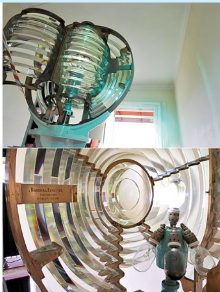
Tallinna sihi alumise tuletorni katadioptriline aparaat, Barbier & Fenestre constructeurs Paris 1886
