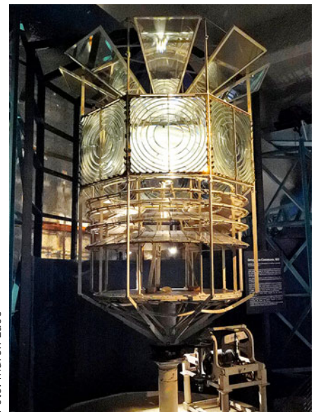
Corduani tuletorni esimene Fresneli optikaga valgusaparaat aastast 1823, paikneb praegu Ouessanti tuletornimuseumis Musée des Phares et Balises
