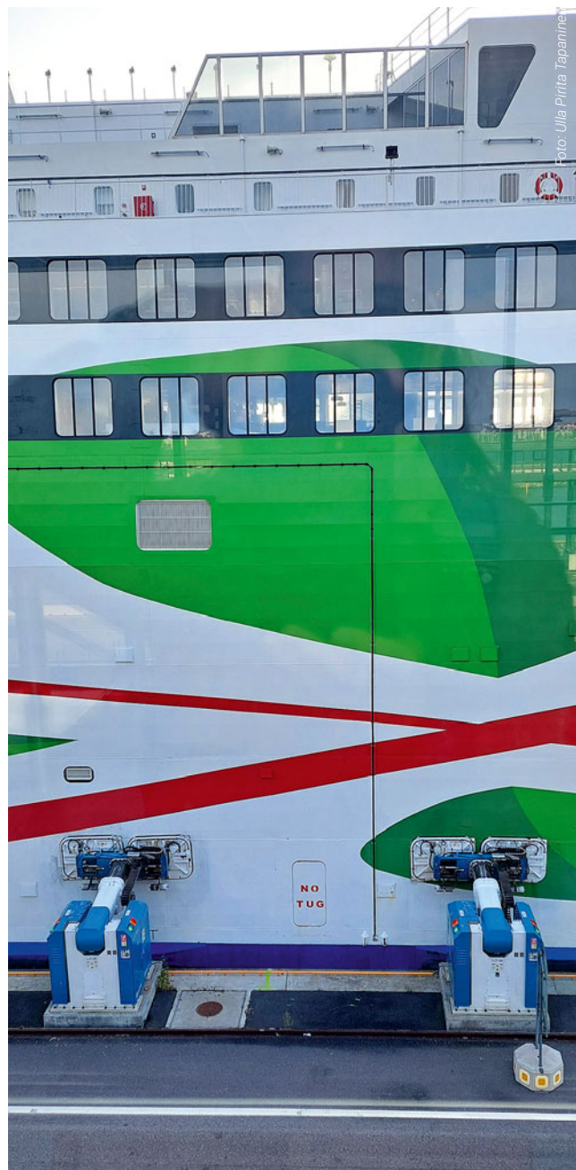
Tallinki laevad „Star“ ja „Megastar“ kasutavad Tallinna ja Helsingi sadamates automaatseid sildumissüsteeme.
