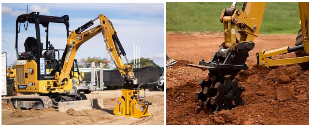
Joonised 4.25 ja 4.26. Ehitusmasinate tööorganite külge paigaldatavad tihendus seadmed: vibroplaat ja tihendamisrattas. [33] ja [34]
