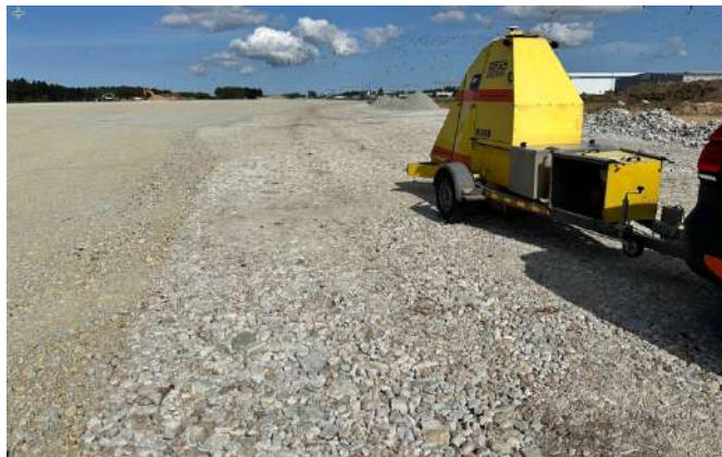
Joonis 10.25. Mõõtmised aherainekihtilt FWD-seadmega. [Foto: Sven Sillamäe]
