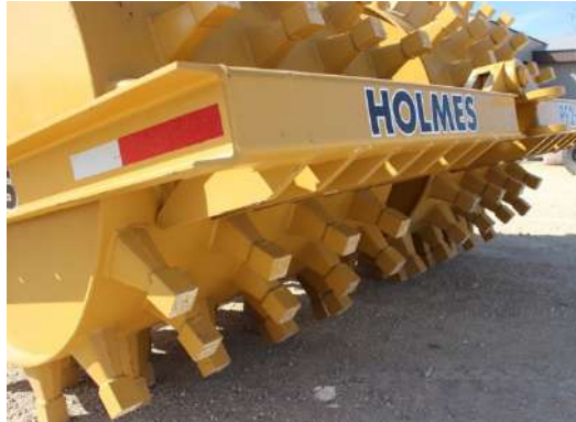
Joonis 4.13. Jalasrulli väljaulatuvad "jalad", mis tungivad plastsesse pinnasesse, aereerivad ja tihendavad seda. [37]
