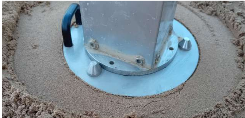
Joonis 10.2: Inspector-seade koos 200 mm tallaga, mida ei kinnitata seadme külge. [Foto: Simmo Talpas-Taltsepp]
