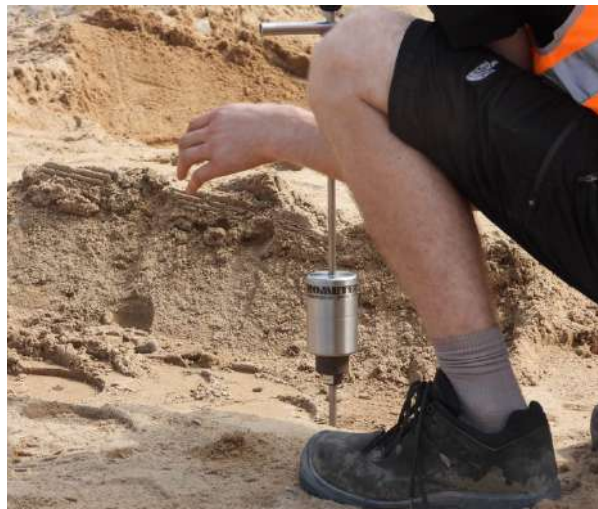
Joonis 10.5: Penetromeetri katse kvartsliidal. [Foto: Simmo Talpas-Taltsepp]
