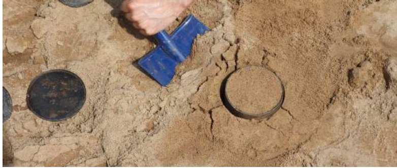
Joonis 10.3: Lõikerõnga proovi võtmine kvartsliidast. [Foto: Simmo Talpas-Taltsepp]
