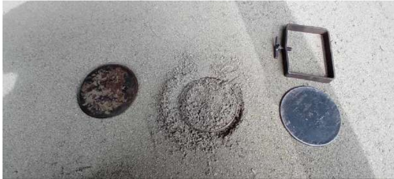
Joonis 10.4: Lõikerõnga proovi võtmine pestud paekiviliivast. [Foto: Simmo Talpas-Taltsepp]
