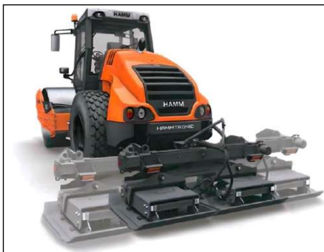
Joonis 4.8. Tihendamaks joonisel 4.7 kujutatud vähema tihedat pealmist kihti on võimalik kasutada taolisi vibrorulli taha paigaldatavaid vibroplaate. [11]
