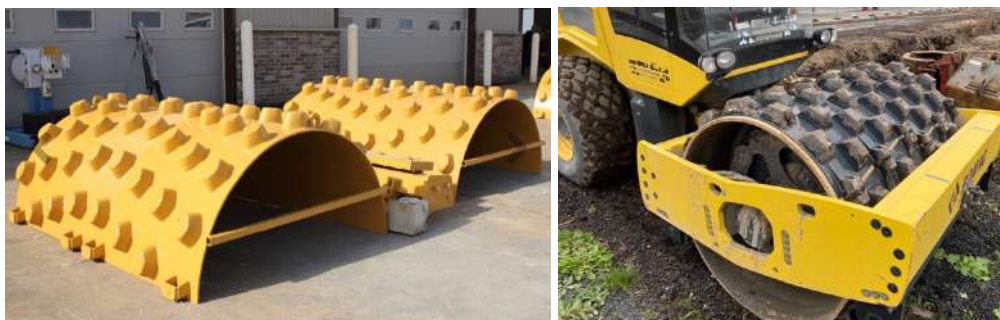
Joonised 4.15 ja 4.16 Tappidega koorikud, mis paigaldatakse vibrorulli silevaltsile (Fotod: J.J. Scheckel Heavy Equipment Corporation [35] ja Sven Sillamäe)
