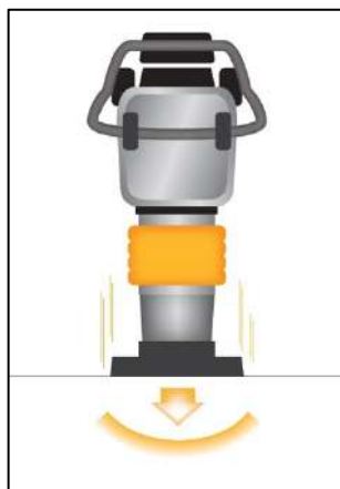
Joonis 4.3. Näiteks vibrotamperid tihendavad löökkoormuse põhimõttel. [10]
