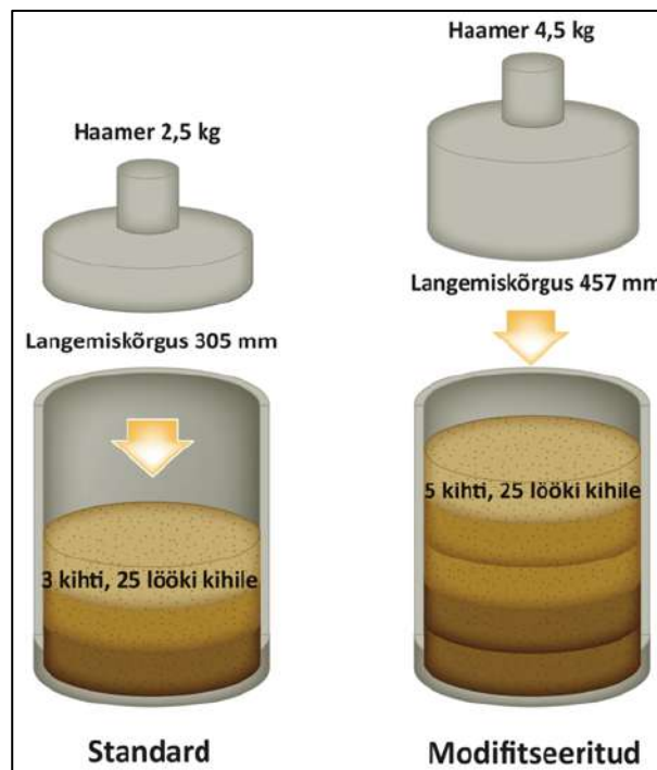
Joonis 1.7. 100 mm läbimõõduga katsekeha standardse ja modifitseeritud Proctor-teimi katsetingimuste võrdlus. [10]
