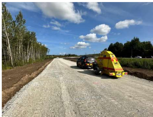
Joonis 10.18: Uuringu raames KUAB FWD mõõtmised killustikalusel, millelt teostati ka kergseadmetega mõõtmine. [Foto: Sven Sillamäe]
