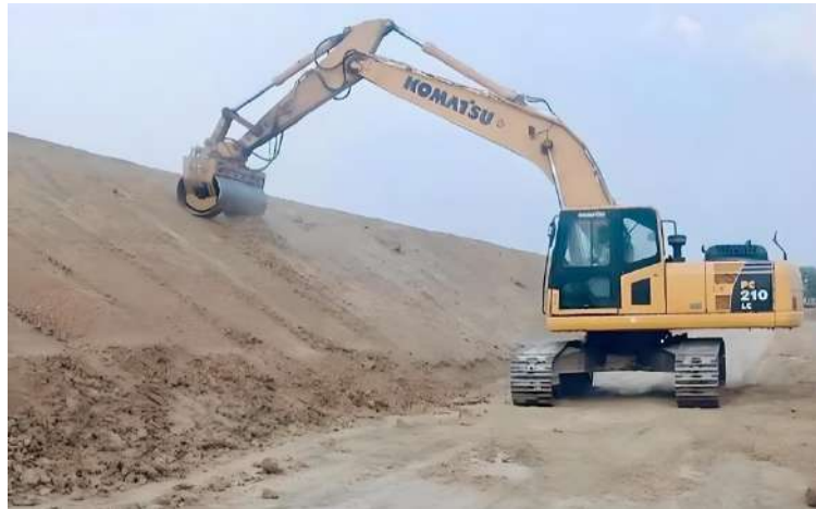
Joonis 4.27. Ekskavaatori tööorgani külge kinnituv nõlvatihendaja. [38]
