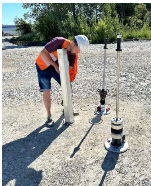
Joonis 10.26. Kergseadmete katsetamine aherainekihtilt, mis on pealt kiilunud. [Foto: Sven Sillamäe]
