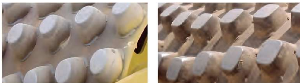
Joonis 4.17. Olenevalt tootjast pakutakse kas ovaalseid ja/või ristkülikukujulisi tappe. Ovaalsed sobivad kõrgema plastsusega pinnastele paremini. [10]
