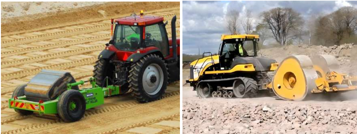
Joonised 4.21 ja 4.22. Suure energiaga lööktihendajad (ing. High Energy Impact Compaction ehk HEIC ). [31]
