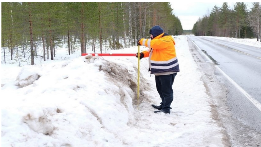
Foto 28 Lumevallide kõrguse mõõtmine mõõdulindi või metalljoonlaua ja vesiloodiga
