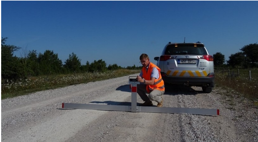
Foto 19 Põikprofili kalde mõõtmine digitaalse kaldelatiga
