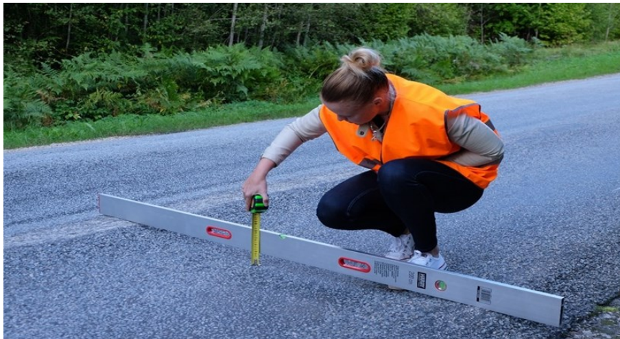
Foto 7 Roobaste sügavuse mõõtmine vesiloodi ja mõõdulindiga
