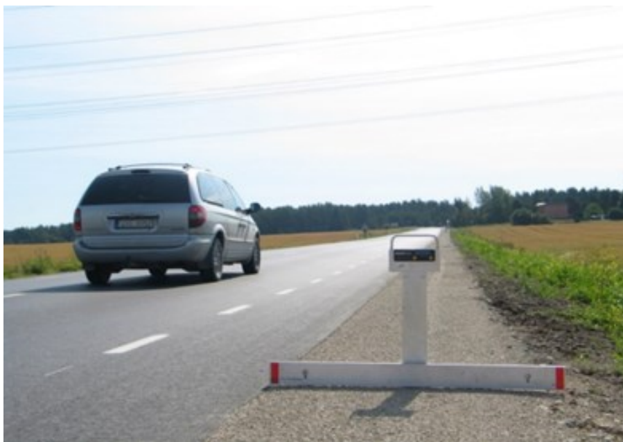
Foto 13 Teepeenra kalde mõõtmine digitaalse kaldelatiga
