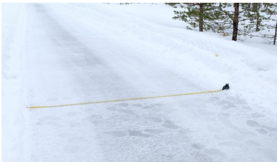
Foto 24 Lumevallide vahelise kauguse mõõtmine mõõdulindiga
