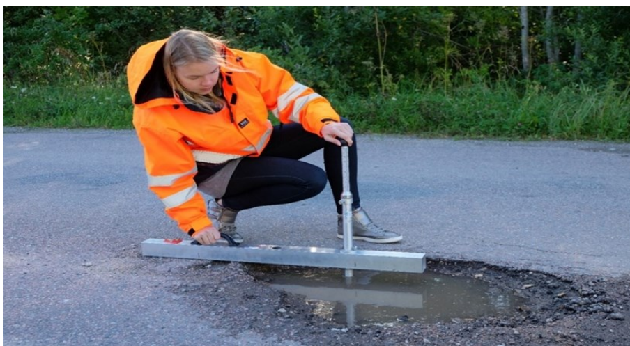
Foto 2 Aukude sügavuse mõõtmine aukude sügavuse mõõdikuga
