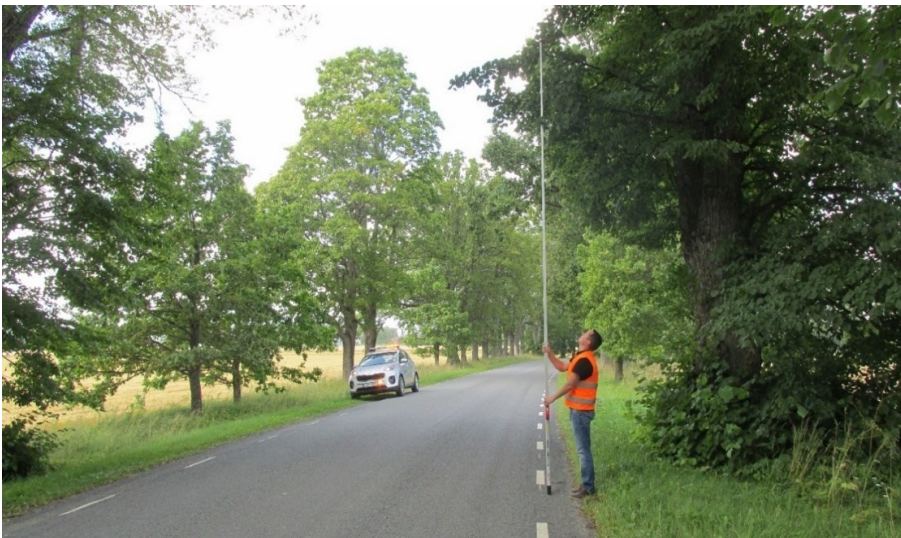
Foto 33 Vaba ruumi mõõtmine teleskoopmõõtelatiga
