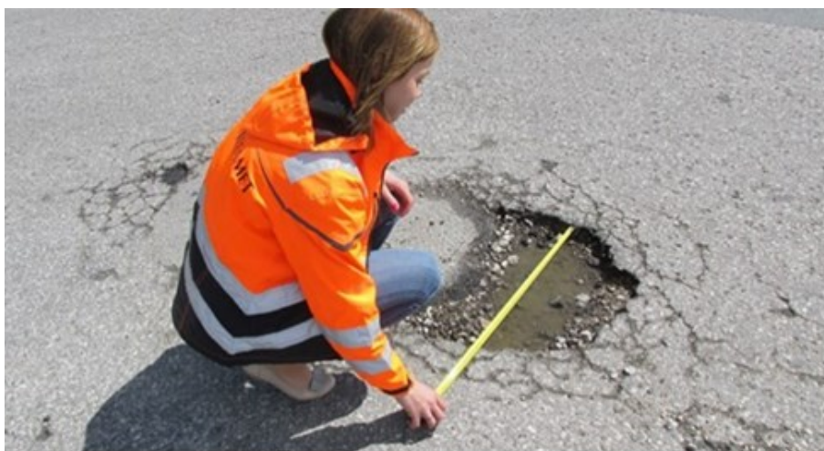
Foto 1 Aukude läbimõõdu mõõtmine mõõdulindiga
