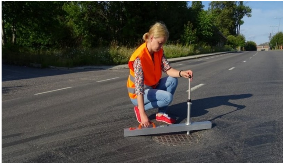
Foto 15 Teekattest madalama tehnovõrgu kaevu või kape kõrguste erinevuse mõõtmine aukude sügavuse mõõdikuga
