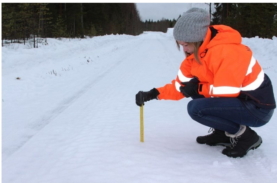
Foto 23 Koheva lumekihi paksuse mõõtmine metalljoonlaua või mõõdulindiga
