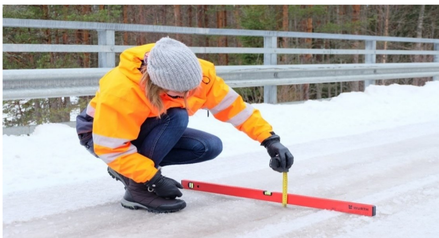
Foto 26 Roopa suurima sügavuse ja ebatasasuse kinni sõidetud lumes või karedas jääs mõõtmine vesiloodi, mõõdulindi või metalljoonlauaga
