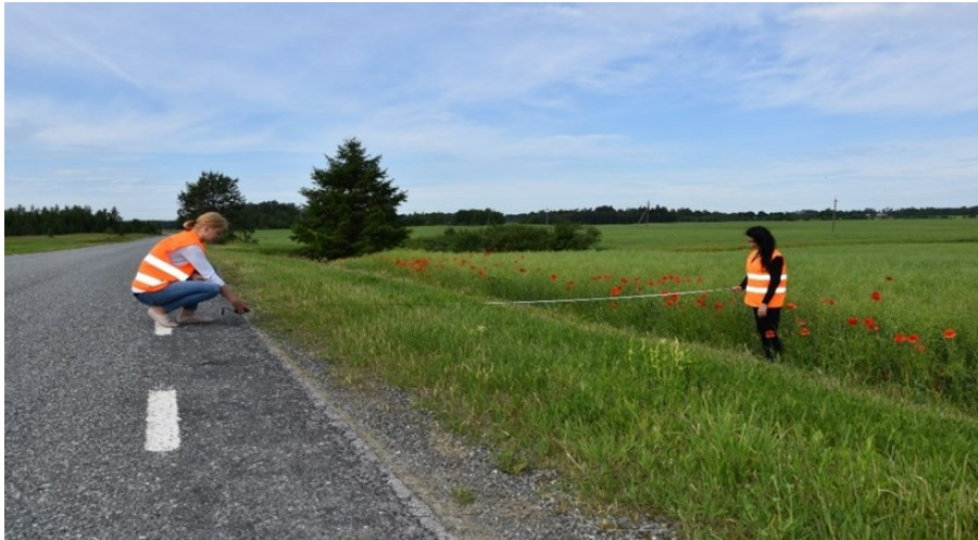
Foto 30 Külgnähtavuse mõõtmine mõõdulindiga
