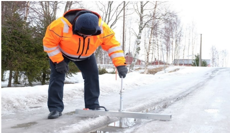
Foto 27 Roopa suurima sügavuse ja ebatasasuse kinni sõidetud lumes või karedas jääs mõõtmine aukude sügavuse mõõdikuga
