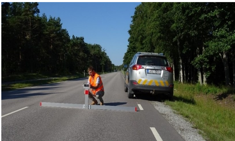
Foto 12 Teekatte kalde mõõtmine digitaalse kaldelatiga
