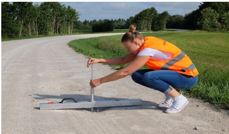
Foto 17 Ebatasasuste mõõtmine aukude sügavuse mõõdikuga
