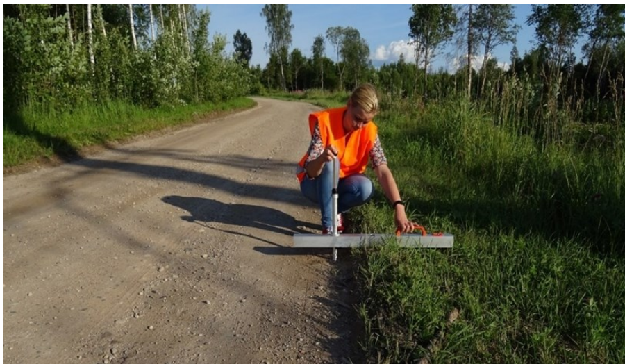
Foto 20 Kruusa- või pinnasevalli kõrguse mõõtmine aukude sügavuse mõõdikuga
