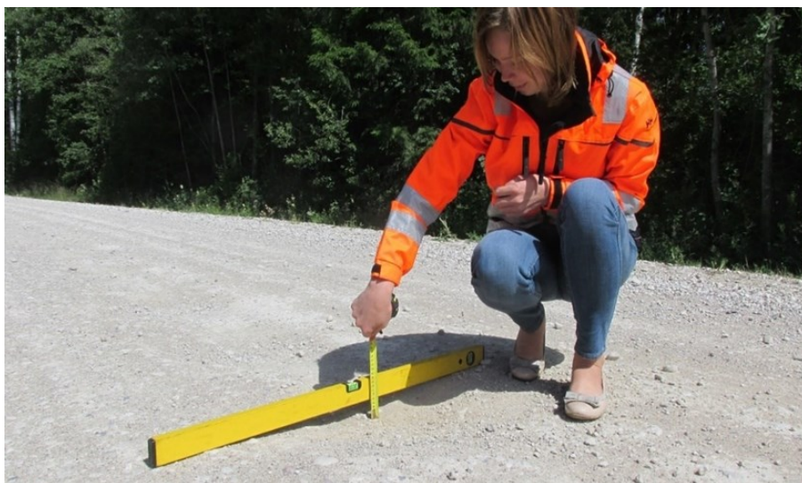
Foto 18 Ebatasasuste mõõtmine vesiloodi, metalljoonlaua või mõõdulindiga
