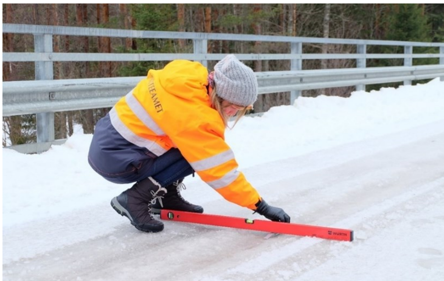
Foto 25 Roopa suurima sügavuse ja ebatasasuse kinni sõidetud lumes või karedas jääs mõõtmine vesiloodi ja mõõtekiiludega
