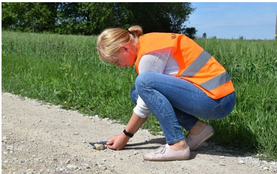
Foto 22 Teel olevate lahtiste kivide läbimõõdu mõõtmine nihikuga
