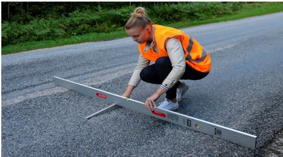
Foto 6 Roobaste sügavuse mõõtmine vesiloodi ja mõõtekiiludega
