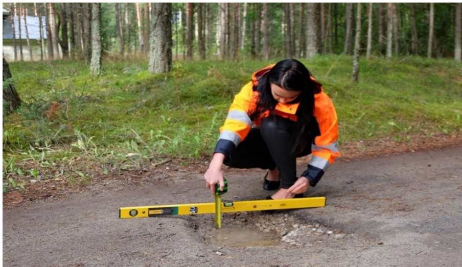
Foto 3 Aukude sügavuse mõõtmine vesiloodi, metalljoonlaua või mõõdulindiga
