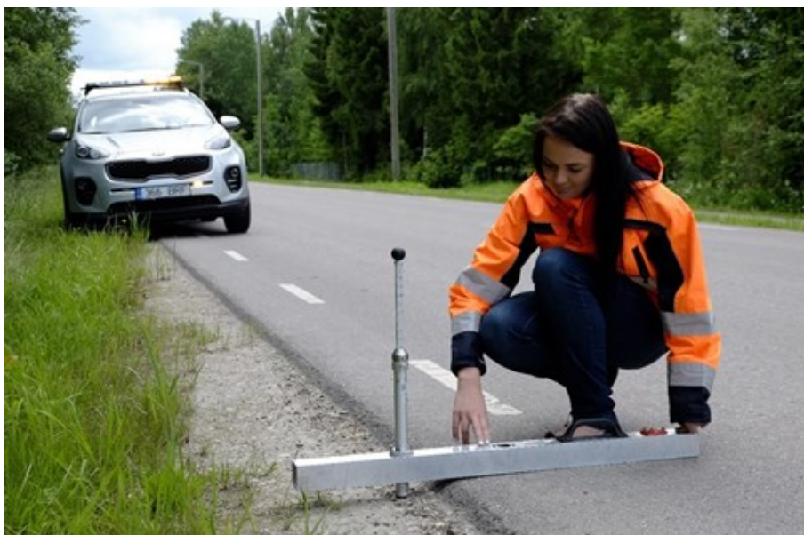
Foto 8 Teekatte ja madalama tugipeenra kõrguste erinevuse mõõtmine aukude sügavuse mõõdikuga
