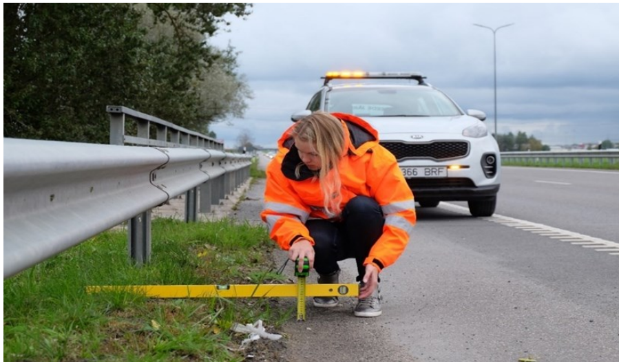
Foto 11 Teekatte ja kõrgema teepeenra erinevuse mõõtmine vesiloodi ja mõõdulindiga
