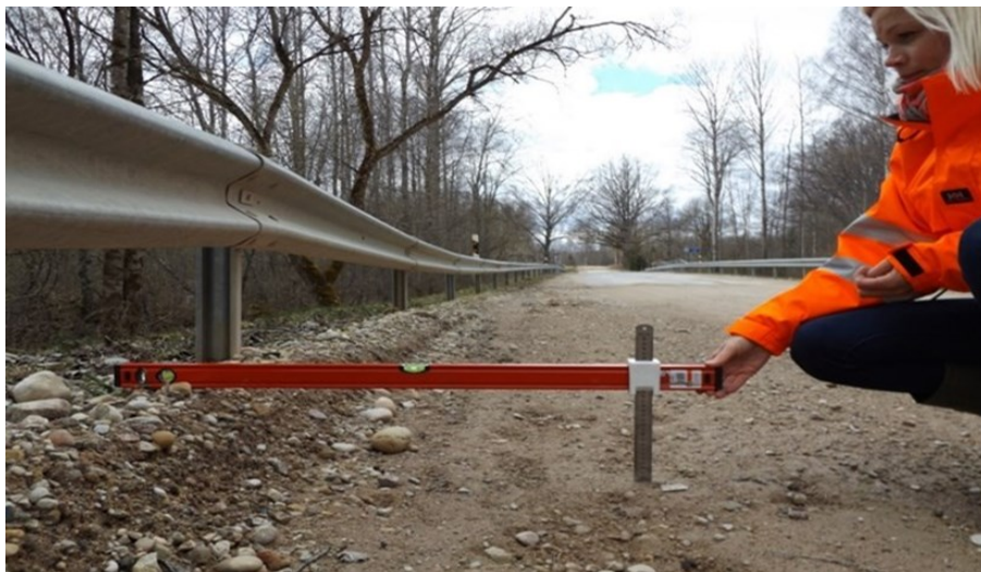
Foto 21 Kruusa või pinnasevalli kõrguse mõõtmine vesiloodi, metalljoonlaua või mõõdulindiga
