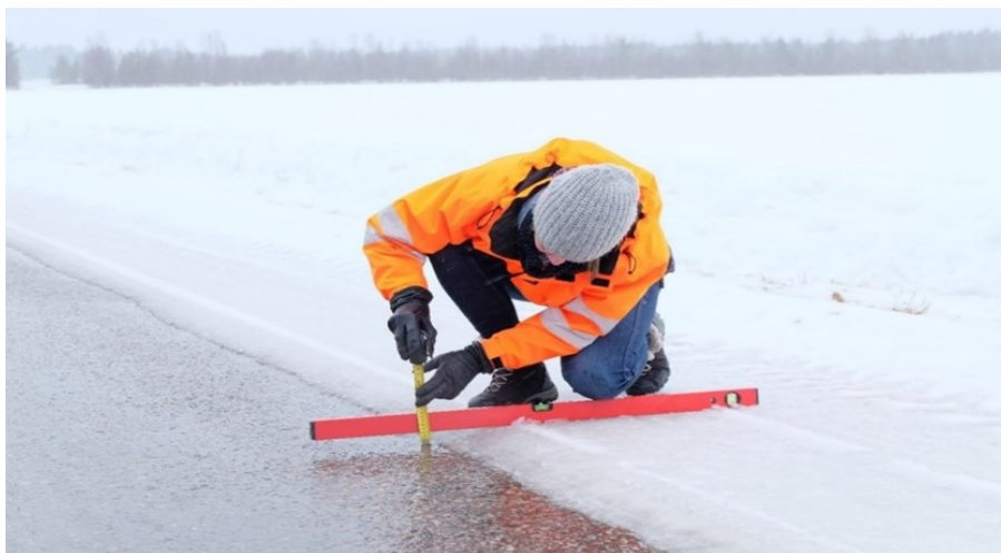
Foto 29 Kattest kõrgema jäätunud peenra mõõtmine vesiloodi ja mõõdulindi või metalljoonlauaga
