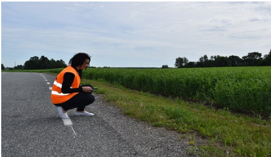
Foto 31 Külgnähtavuse mõõtmine laserkaugusmõõtjaga
