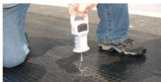
Joonis 25: Geosünteedi ja aluspinna vahelise nakke kontroll. 6
