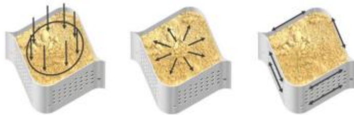
Joonis 13: Geokärje tööpõhimõte 3
