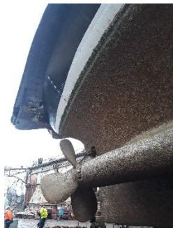
Ka jäämurdja põhi vajab puhastamist ja kattumisevärviga katmist. Pildi tegi Mairold.
